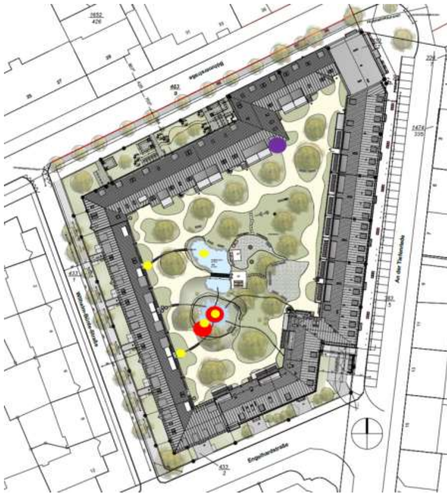
Bild 2-3: Messpunkte im Innenhof (Südstadt). Gelbe Punkte sind Messungen der Wassertemperaturen (HOBO Datenlogger), der lilafarbene Punkt zeigt die Messung der Globalstrahlung, die roten Punkte sind die Messtation (unterer Punkt) und die Messung des Wasserdrucks (Mitte tiefer Teich). Bildquelle: Architekturbüro Kozjak
