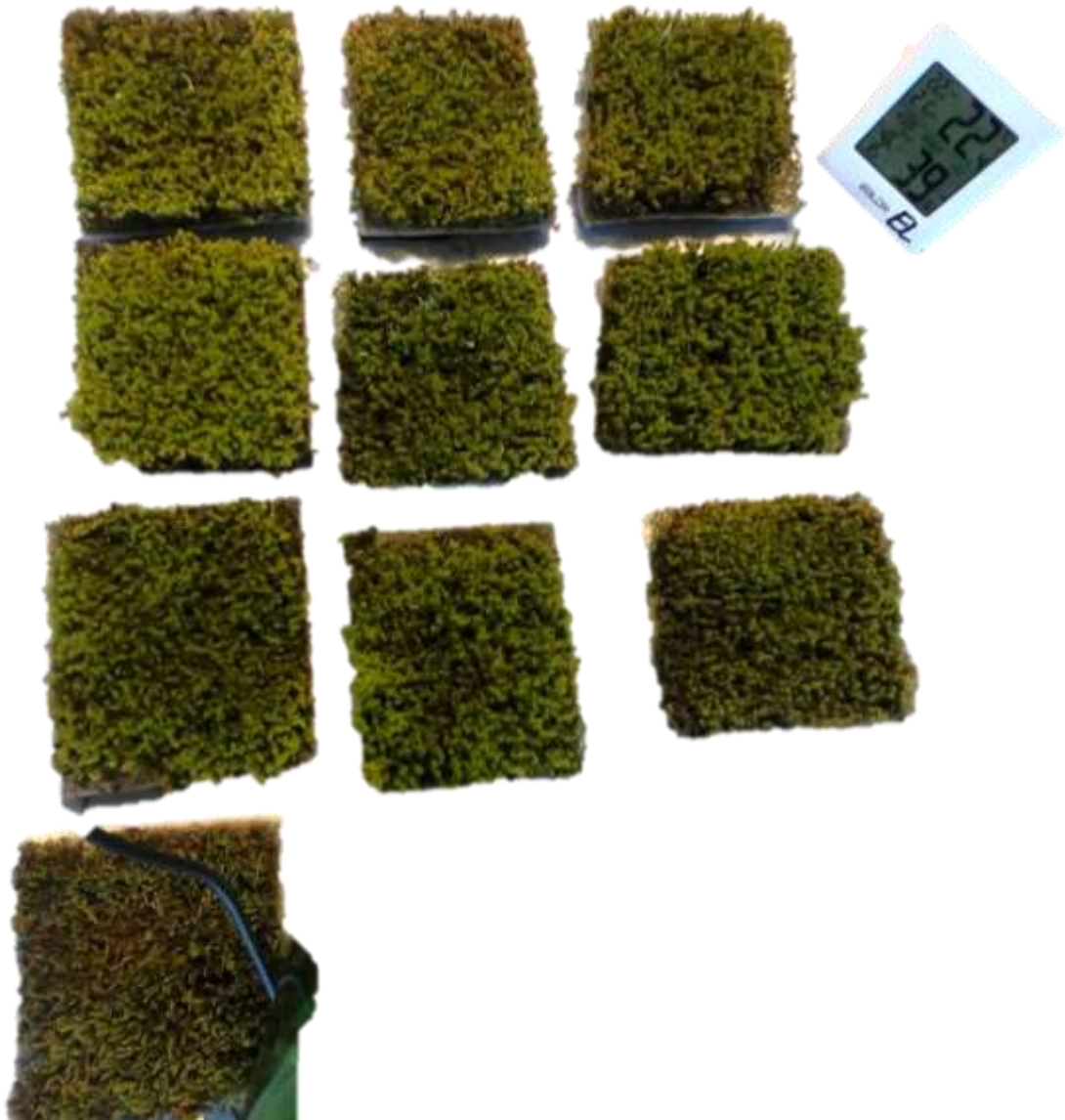
Bild 2-4: Moos-Versuche im Labor. Dreifachansatz mit Triplikaten und Referenzplatte zum Vergleich (unten links), Quelle: FWJ Mareike Ellmann am ISAH.
