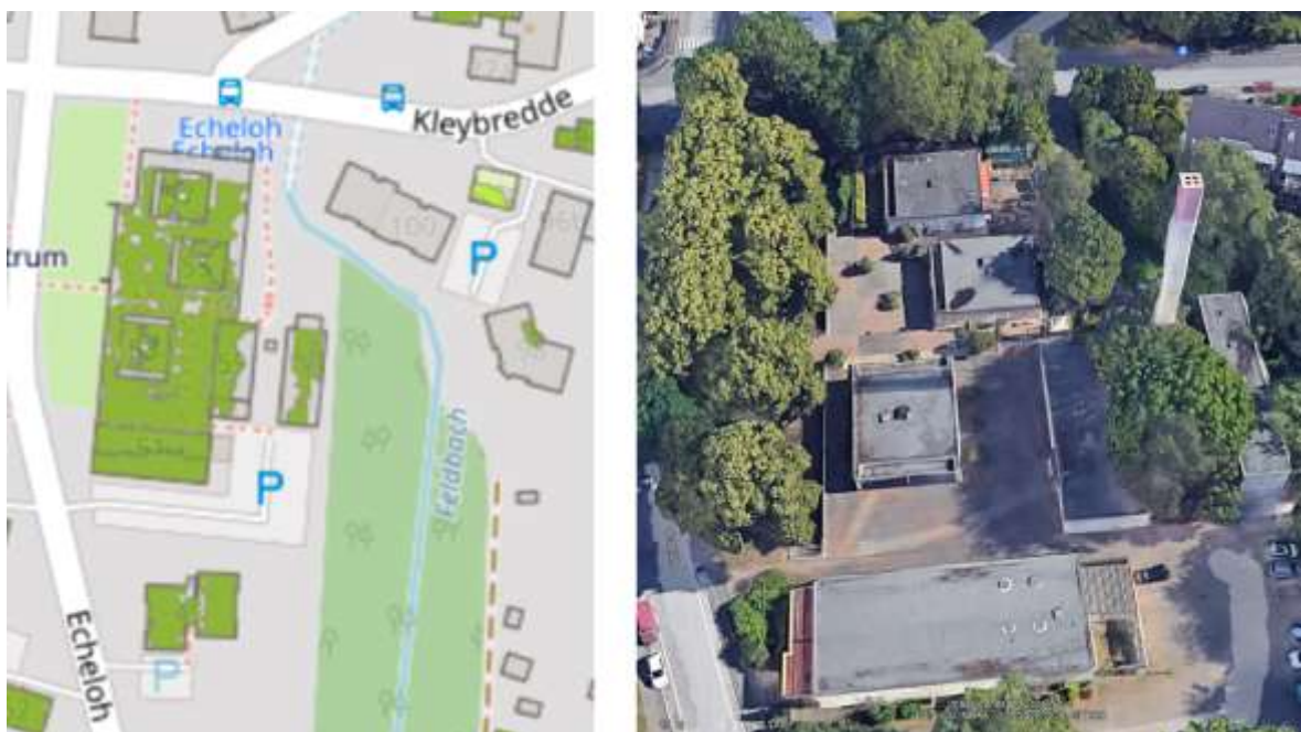
Bild 3-19: fälschliche Ausweisung verschatteter Bereiche des Daches als „ungeeignet“ aufgrund angrenzender Gebäude und Bäume [Quelle: QGIS 2022; Google Earth 2022]
