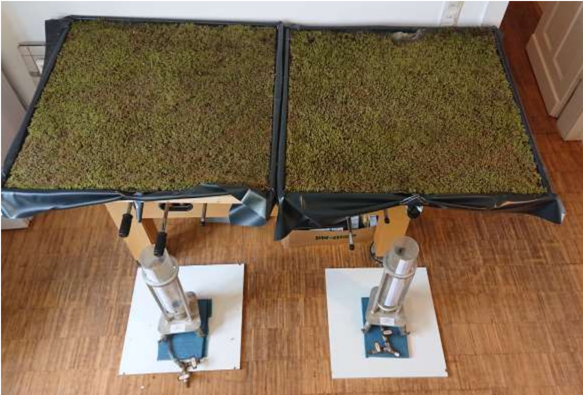
Bild 5-3: Eigene Abflussmessungen zur Retentionsleistung von Moosmatten bei 1% und 0% Dachgefälle [Quelle: eigene Darstellung]
