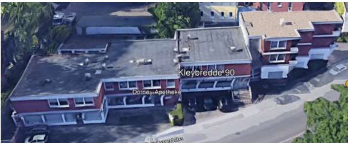
Bild A 1: Bestimmung des Parameters „ehemals bekiest“ anhand gleicher Gebäudekonstruktion (Google Earth 2022)
