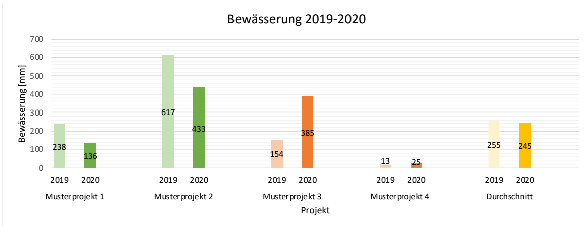
Bild 2-4: Gegenüberstellung des zusätzlichen Wasserbedarfes [in mm bzw. l/m 2 a] ausgewählter Projekte in den Jahren 2019 und 2020. Grün: Hochbeete mit hauptsächlich mit Leitungswassernutzung, Rot: ebenerdiger Projekte hauptsächlich mit Regen- und Grundwassernutzung, Gelb: Durchschnitt
