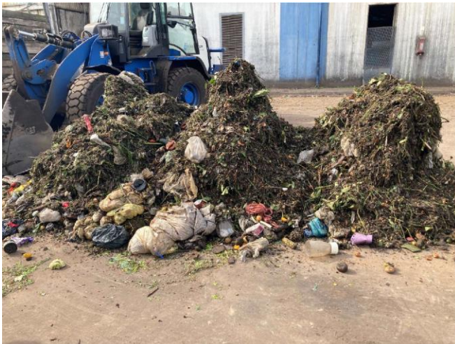
Abbildung 2: Haufwerk aus den beprobten Bioabfalltonnen [Quelle: Oelke, 2021]
