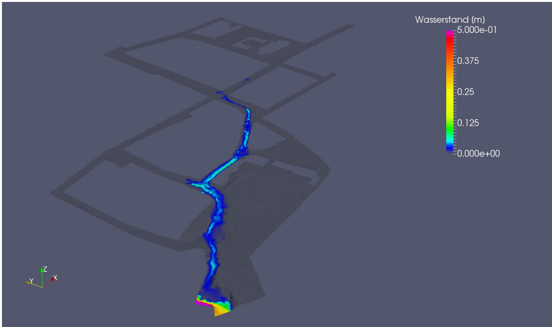
Bild 3-11: Gekoppelte 1D-Kanalnetz-/ 2D-Oberflächenabflussberechnungen für den Fließweg Markt-Mühlengraben ohne Berechnung der Oberfläche, Lastfall MR60 n=0,02 [1/a]
