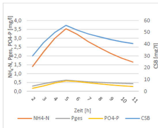
Abbildung 69 theoretische Entwicklung der Ablaufkonzentration NK 4 (BP-Versuch 4)
