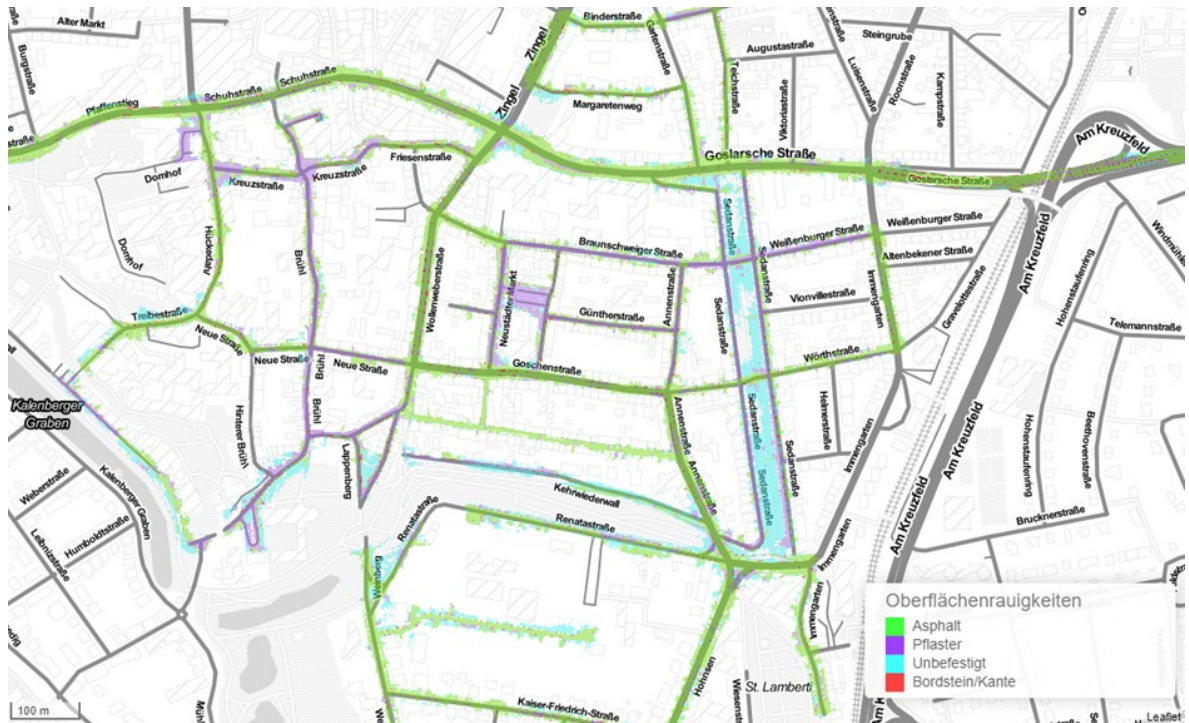
Abbildung 4-1-7: Ergebnis der Klassifizierung der Geländeoberfläche (Asphalt, Pflastersteine, Gras, Bordsteinkante) für die Neustadt in Hildesheim
