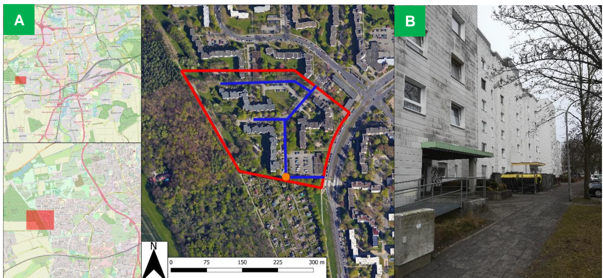
Abbildung 3: [A] Einzugsgebiet des Typs Bestand mit Einzugsgebietsgrenzen (rot), Trennkanalisation (blau) und Messstelle (orange); Koordinaten der Messstelle 52.247022700468094°N, 10.469478825597816°E (Bilder © 2022 AeroWest, CNES / Airbus, GeoBasis-DE/BKG, Maxar Technologies, Kartendaten © 2022 GeoBasis-DE/BKG (© 2009), bearbeitet) und [B] typische Wohnbebauung im Bestandsgebiet (eigene Darstellung, ISWW)
